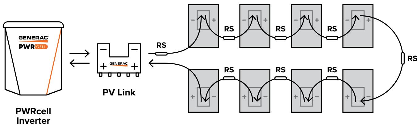
*El diagrama es aplicable para la mayoría de los módulos FV de 60 celdas. Los módulos con una mayor cantidad de celdas pueden requerir un arreglo distinto. Contacte a Generac para más detalles.*
