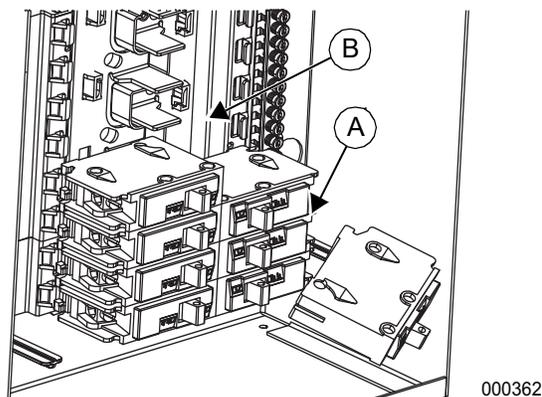
**Figure 3-3. Install Breakers**
